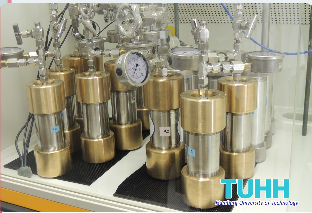
Vessels simulate deep sea conditions to understand biodegradation at high pressures. Vasos simulan condiciones de aguas profundas para entender la biodegradación a presiones fuertes.
